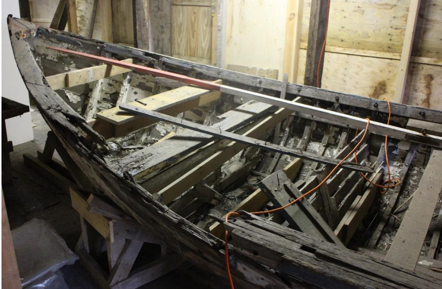
Guðrún Helga SU. Borðstokkur og byrðingur eru brotnir eftir að báturinn fauk. Ljós. HMS 2018
